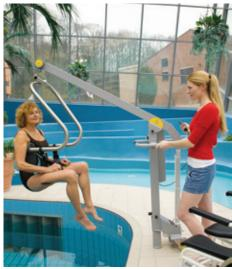
Для облегчения перемещения людей с ограниченной подвижностью в ванну или бассейн используют подъемные устройства. Подъемники для спуска пациентов в воду могут устанавливаться на обходной дорожке бассейна, крепиться к потолку или стене.
